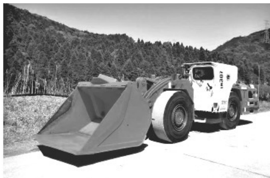
菱刈鉱山に導入されたSandvik社(スウェーデン)のTOROTM LH307地下ローダー
