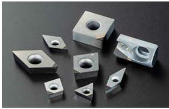
スミダイヤは、最も硬度の高いダイヤモンドと結合材を高圧高温下で焼結したPCD焼結体で、アルミ合金の加工をはじめ、切削加工の難しい超硬合金や硬脆材の加工が可能な工具
